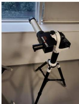
太陽はとてつもなく明るいため、直視することは失明の恐れがあり大変危険です。そのため太陽を観測するには、適切な減光が施された専用の機材が必要です。そこで、活動では左図の太陽望遠鏡を用いて太陽の観測を行っています。
