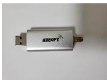
WASAでの活動では、左図のAIRSPYというものをパソコンに接続し、アンテナとケーブルで接続して観測を行っています。
